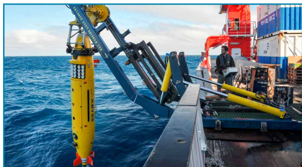
... und ins Wasser hinabgelassen. Das torpedoähnliche Gerät ist mit zahlreichen Messinstrumenten ausgestattet.
