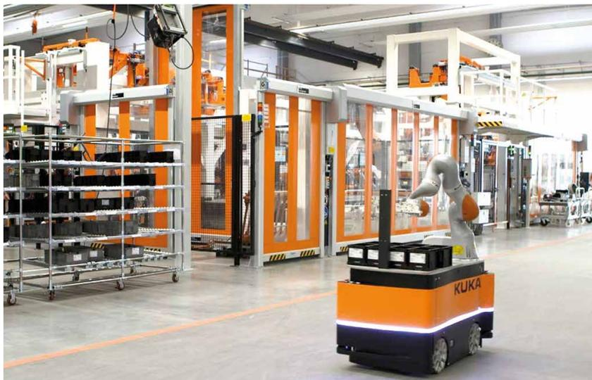
*Dieser Roboter fährt selbstständig durch eine Lagerhalle, holt Bauteile aus einem Regal und bringt sie dorthin, wo sie benötigt werden.*
